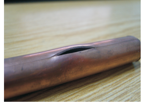
Geplatze Rohre wie dieses sorgten für abenteuerliche Temperaturen im "Guten Haus"!
